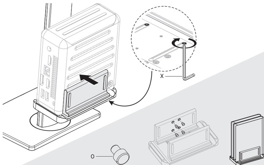
Если держатель для ПК используется исключительно в качестве подставки или полки для хранения, вставьте заглушки (O) в отверстия установки вместо винтов (R), как показано на рисунке.
