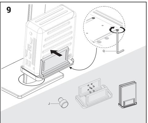
Если держатель для ПК используется исключительно в качестве подставки или полки для хранения, вставьте заглушки (J) в отверстия установки вместо винтов (M), как показано на рисунке.
